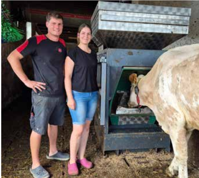
Josef und Petra Zehetgruber betreuen für 6 Wochen den Greenfeeder zur Messung von Methan und CO 2 aus der Atemluft der Kuh.
