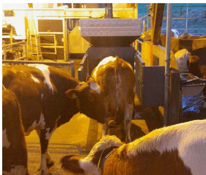
Das Foto zeigt im Hintergrund eine GreenFeed-Station zur standardisierten Messung der Methanemissionen von Rindern. Derzeit gibt es in Österreich zwei dieser Systeme. Das Gerät misst Methan- und CO 2 -Ausscheidungen bei Einzelkühen.
